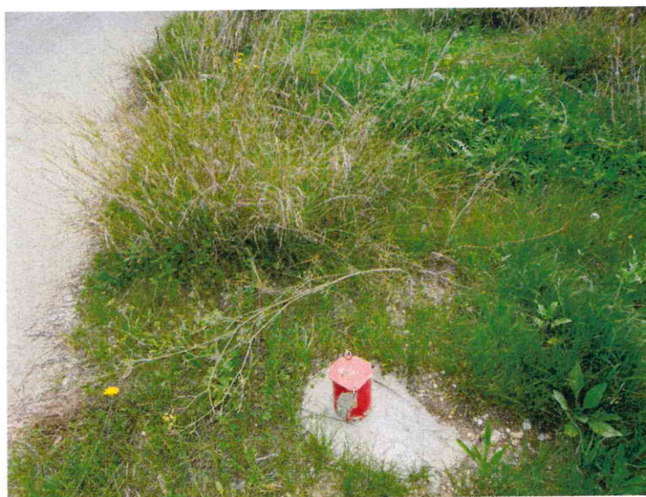
Strada Mare e Monti S4 Pozzetto piezometro
