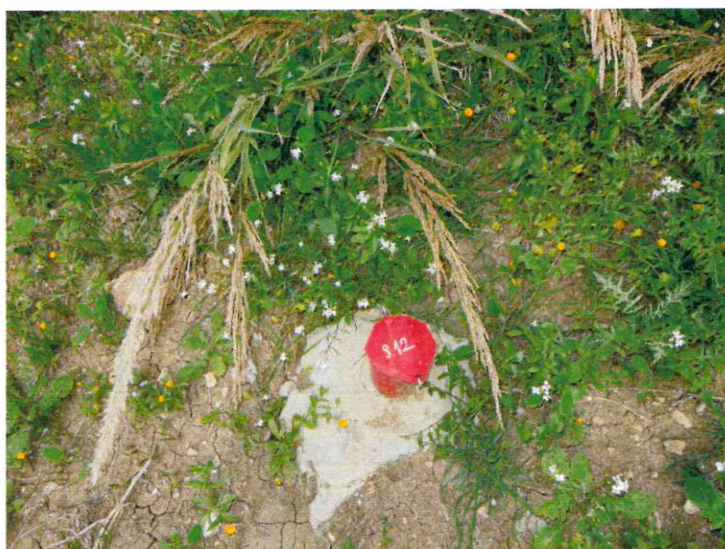
Strada Mare e Monti S12 Pozzetto Piezometro
