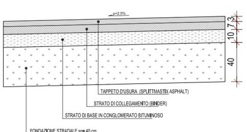
SEZIONE TIPO IN RILEVATO IN ALLARGAMENTO DI RILEVATO ESISTENTE
