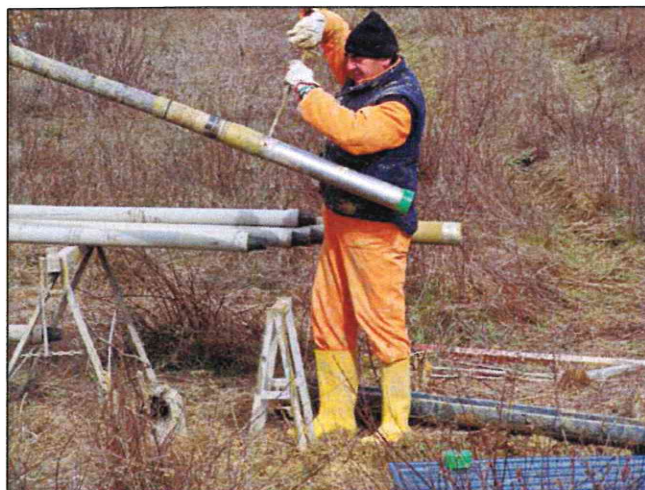
Foto 3: Prelievo di campione mediante campionatore Shelby (foto di repertorio)
