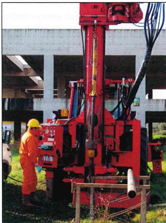
Foto 2: Esecuzione prova penetrometrica SPT (foto di repertorio)
