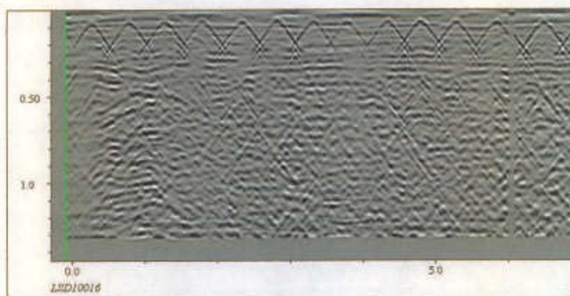
LSD-12, 13, 14 e 15: Solaio in c.a. con diverse geometrie di armature.
