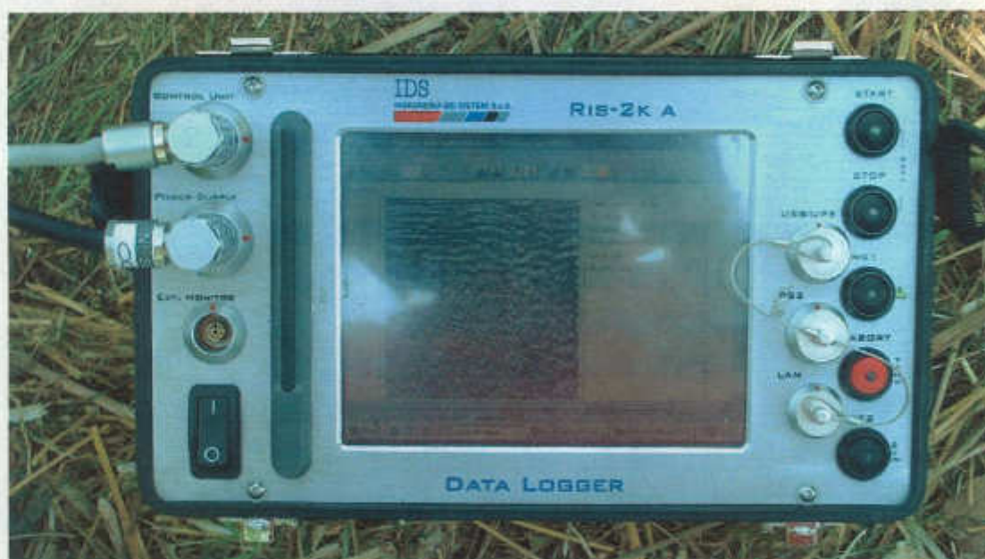
Figura 1 – Data Logger per la gestione dell'acquisizione ed archiviazione dei dati radar
