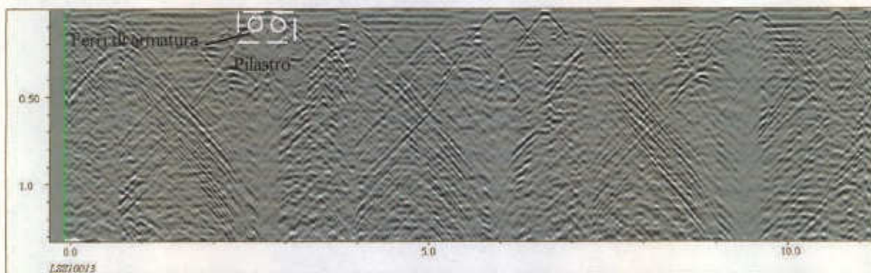
LSS-11 e LSS-12: Scansioni su solaio con diverse disposizioni delle armature.
