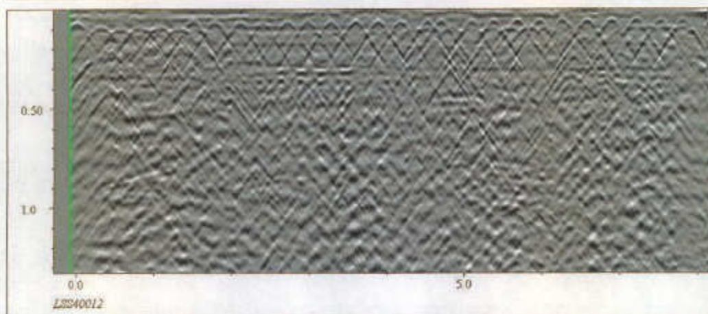
LSS-11 e LSS-12: Scansioni su solaio con diverse disposizioni delle armature.
