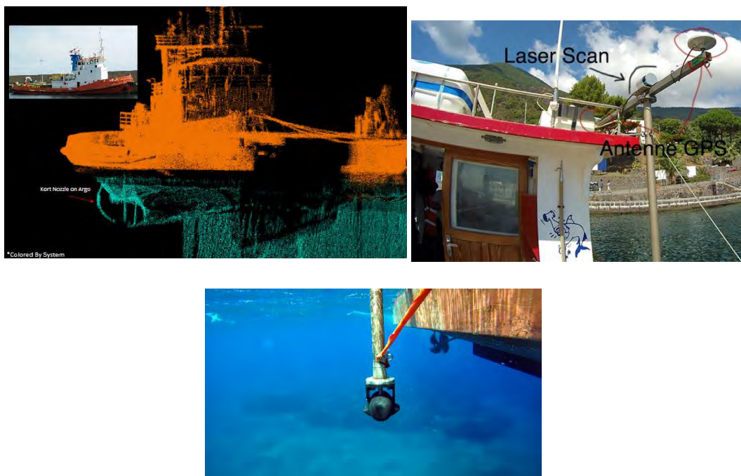
Figura 1 Esempio rilievo Multibeam e laser scan – Trasduttore Multibeam
